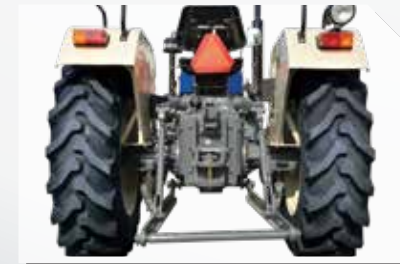
एडजस्टेबल व्हील ट्रैक दरम्यानी खेती के लिए उपयुक्त
