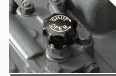
आइसोलेटर वाल्व निचले लिंक्स को ऊंचा किए बिना टिपिंग ट्रेलर को उठाने के लिए
