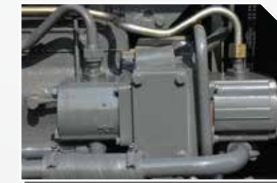
डबल पंप चलित पावर स्टीयरिंग* मोड़ों पर डाइड्रॉलक्स तथा स्टीयरिंग बेहतर तरीके से काम करने लिए
